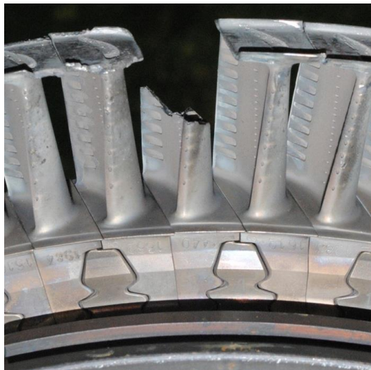
Рис. 1. Разрушение рабочих лопаток
