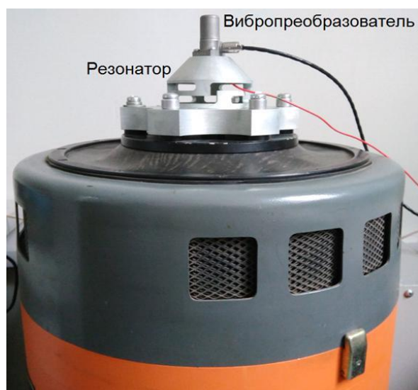
Рис. 3. Вибростенд Instron с резонатором и исследуемым вибропреобразователем
