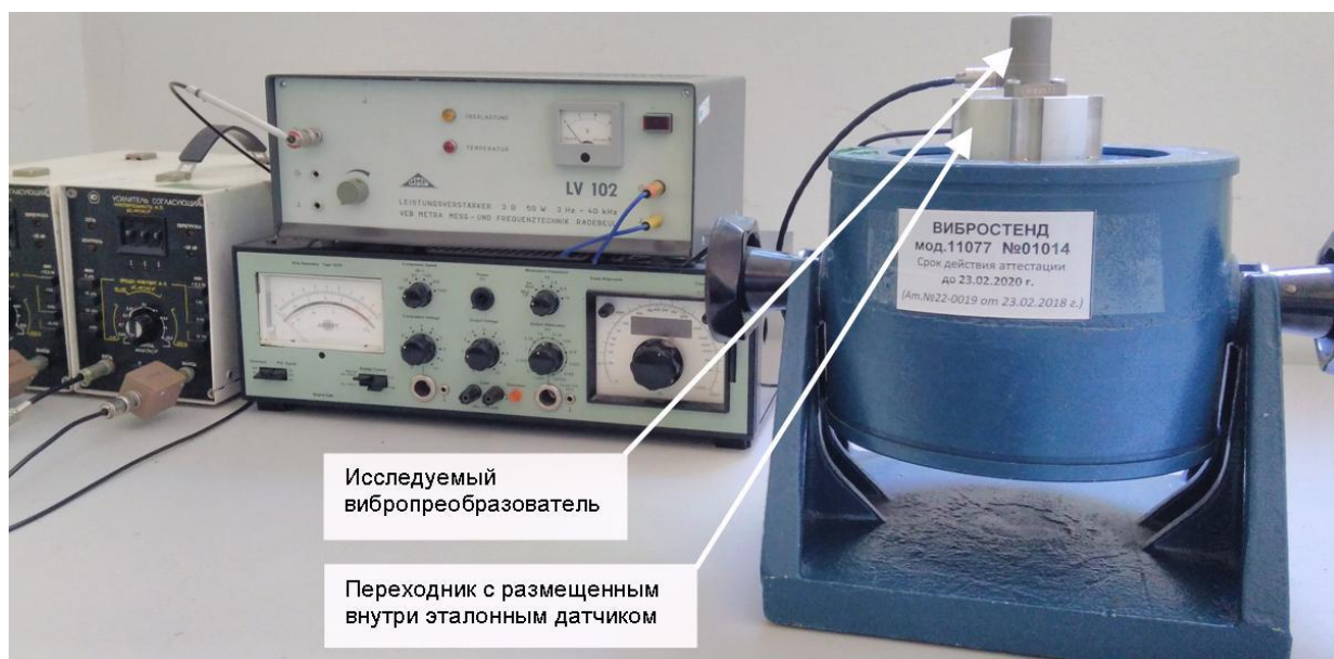
Рис. 2. Рабочее место с малогабаритным вибростендом ESE 221, организованное в АО «Элемент»
