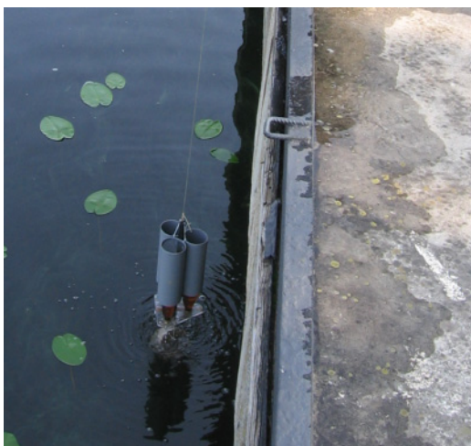
Рис. 2. Подъем седиментационных стаканов с осевшей взвесью
