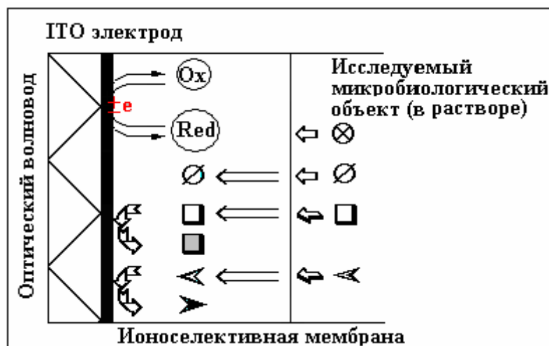
Рис.8. Схема оптоэлектрохимического биосенсора. Обозначения: \otimes – вещества не проникающие в плёнку; \emptyset – вещества проникающие в плёнку, но не подвергающиеся Red-Ox превращениям; o – вещества проникающие в плёнку, подвергающиеся Red-Ox превращениям и дающие сигнал, но не на “аналитической” длине волны; \otimes – вещества проникающие в плёнку, подвергающиеся Red-Ox превращениям, продукты которых дают сигнал на “аналитической” длине волны.
