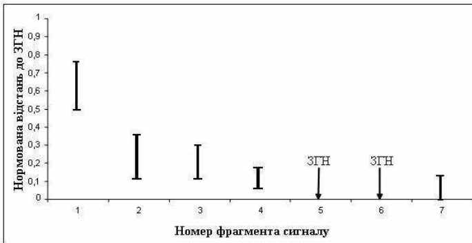
Рисунок 8 – Результат виявлення зворотного гортанного нерва на основі інтервальної моделі з радіально-базисними функціями
