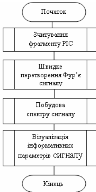
Рисунок 3 – Алгоритм отримання інформативних параметрів результуючих інформаційних сигналів
