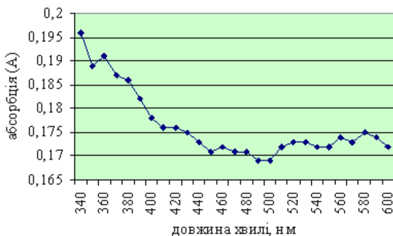
Рис.2 – Графік залежності абсорбції (A) молока фальсифікованого водою (вода 25% – молоко 75%) від довжини хвилі ( \lambda , нм)
