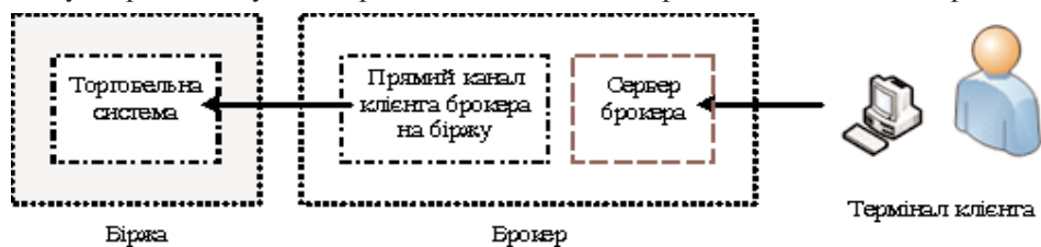
Рис. 3. Схема доступу до торгів на біржі через проміжні брокерські системи та шлюз спеціального призначення, авторська розробка
