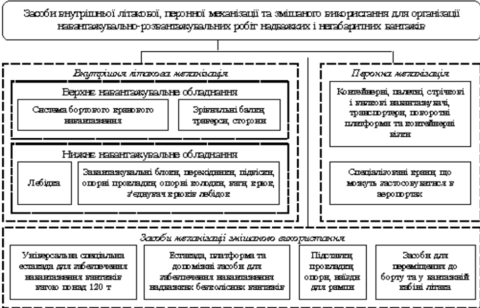
Рис. 1. Засоби механізації для організації навантажувально-розвантажувальних робіт надважких і негабаритних вантажів, розроблено за даними [11]
