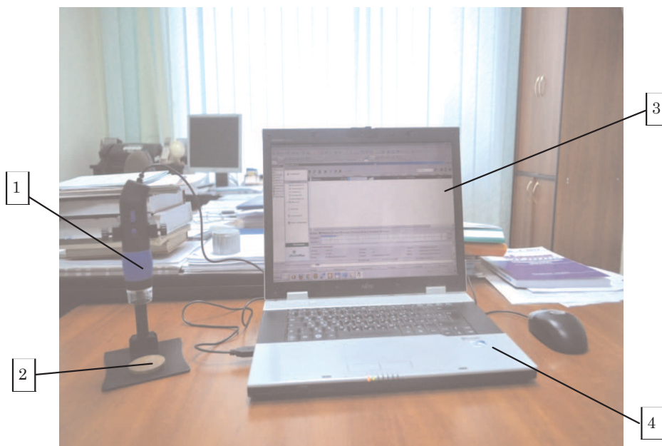
1 – мікроскоп; 2 – шліф досліджуваного матеріалу; 3 – інтерфейс програми Smart-eye; 4 – персональний комп'ютер.
