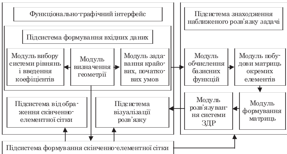
Рис. 3. Структура програмно-апаратного комплексу, складено за даними [8; 9]
