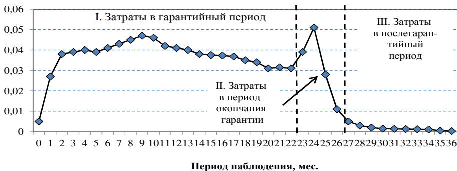
Рис. 1. Изменение долей затрат на устранение отказов в гарантийный период эксплуатации автомобилей, построено по материалам [5]
