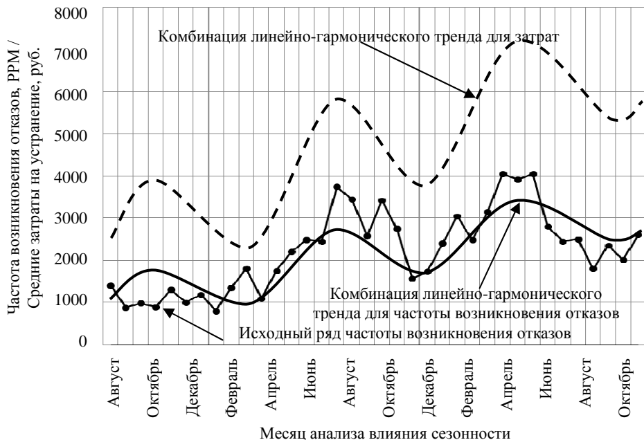
Рис. 3. Анализ влияние факторов сезонности на отказ (течь) сальника коленчатого вала двигателя, построено по данным [9, 323–326]
