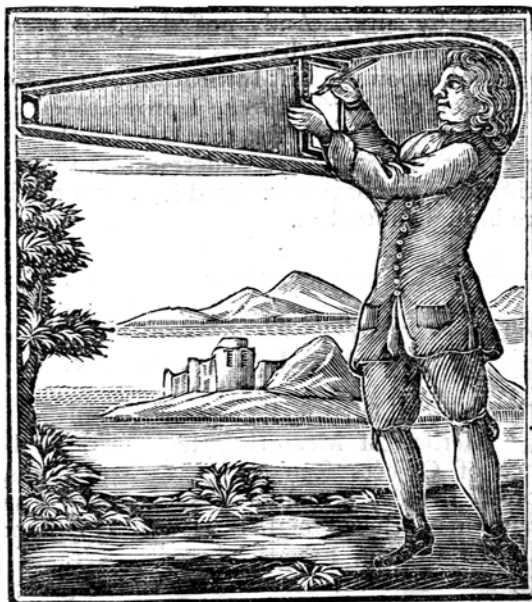
Камера-обскура конструкції Р. Гука. Лондон. 1670
