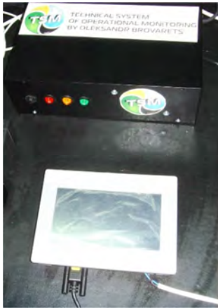
Рис. 10. Апаратна частина, блок керування та дисплей для керування інформаційно-технічної системи локального оперативного моніторингу агробіологічного стану ґрунтового середовища сільськогосподарських угідь конструкції Олександра Броварця.
