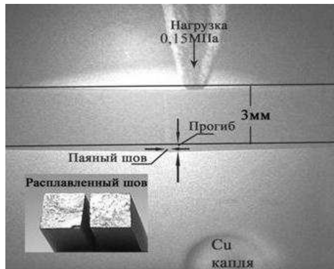
Рис. 4. Керамический паяный образец, повторно нагретый до 1100 °C под нагрузкой 0,15 МПа, и вид торцов керамики после расплавления шва [(Cu—5Ni)—Nb 50 мкм — (Cu—5Ni)]. Фото при 1100 °C
