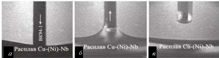
Рис. 1. Натекание и оттеkanie расплава Cu—Ni—Nb с пластинки из ВК94-1 при T = 1150\text{ }^{\circ}\text{C} : a — погружение пластинки в расплав; б, в — частичное и полное извлечение соответственно
