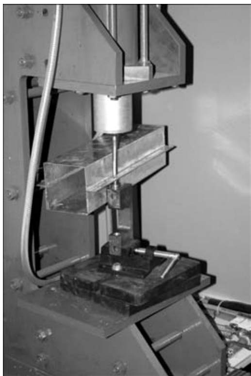
Рис. 7. Внешний вид пневмопресса для формирования механических соединений
