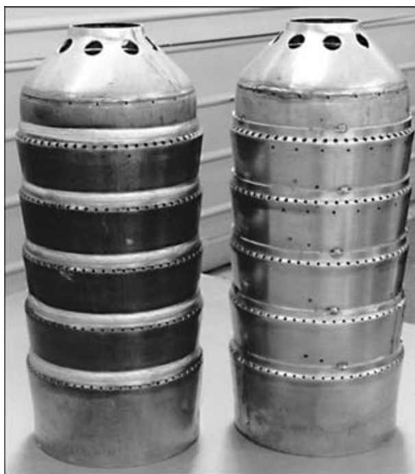
Рис. 3. Внешний вид жаровой трубы (сплав ЭИ 602, \delta = 2,5 мм) с пятью кольцевыми швами, выполненными ЭЛС
