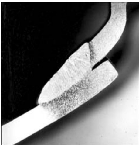
Рис. 2. Макрошлиф нахлесточного соединения обечаяк жаровых труб, полученного ЭЛС
