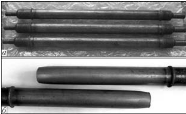
Рис. 3. Автомобильная деталь рулевой тяги диаметром 22×2,2 мм после сварки (а) и после испытаний на разрыв (б)
