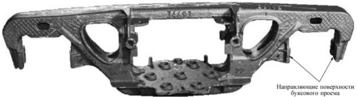
Рис. 1. Боковая рама двухосной тележки грузового вагона модели 18–100
