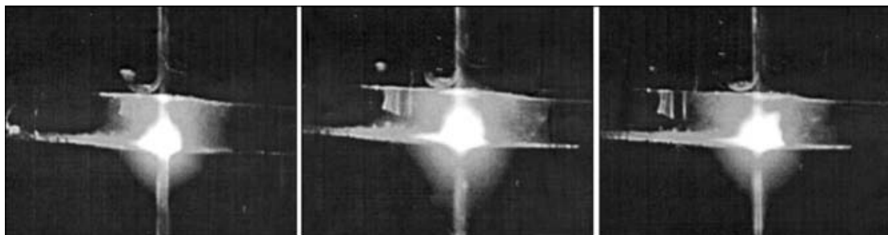
Рис. 7. Три последовательных фрагмента фаз горения дуги при электродуговой сварке под флюсом, полученные посредством эксперимента (см. рис. 6) (процесс сварки происходит слева направо)
