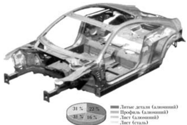
Рис. 1. Конструкция корпуса Audi TT из разнородных металлов [4]
