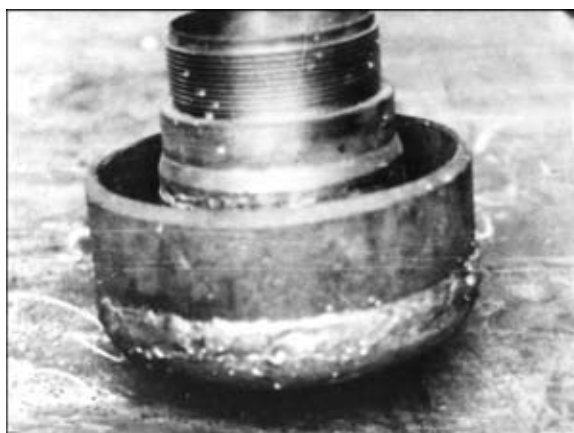
Рис. 2. Внешний вид фурмы после сварки медного рыльца со стальным кольцом
