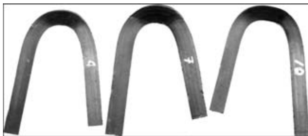
Рис. 7. Внешний вид сварных образцов меди со сталью после их испытания на изгиб
