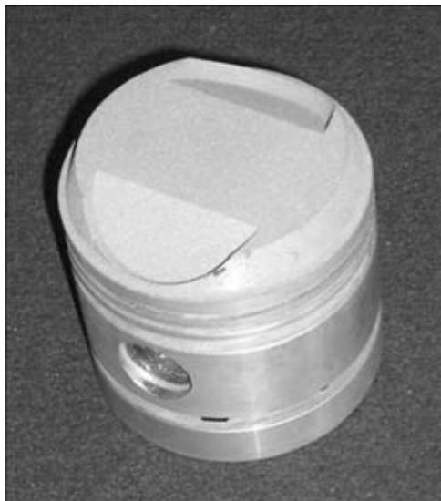
Рис. 7. Поршень из алюминиевого сплава с теплозащитным покрытием
