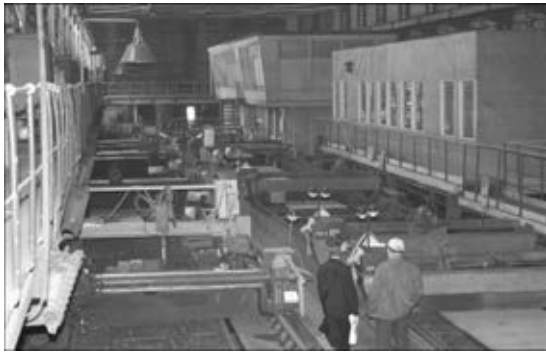
Рис. 6. ГАУ с машинами типа «Кристалл» для тепловой резки
