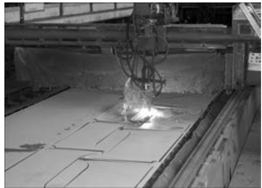
Рис. 7. Плазменная резка в плазмообразующих средах с добавлением воды
