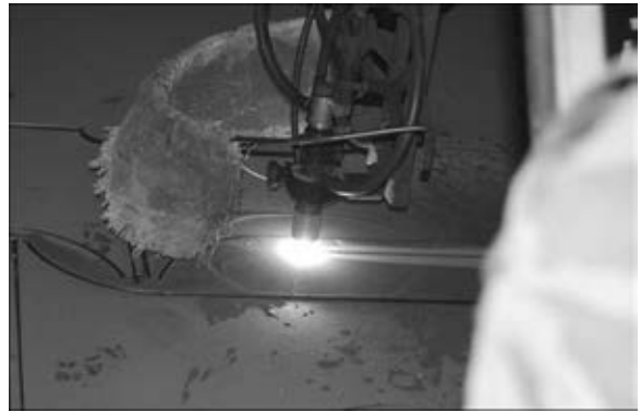
Рис. 4. Процесс резки (плазмообразующая среда воздух + вода)
