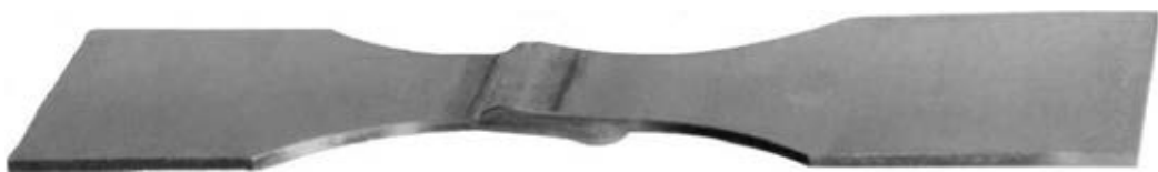
Рис. 3. Образец нахлесточного соединения для испытаний на усталость
