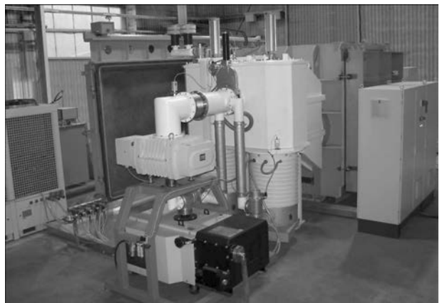
Рис. 3. Вакуумная система откачки установки ЭЛУ-20 с автономным водяным охлаждением вакуумных насосов, ЭЛП и источника питания (чиллер типа BL365-16, фирма «Lahntechnik», Германия)
