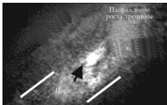
Рис. 9. Образование микропоры в образце стали IN903, содержащей водород [54]
