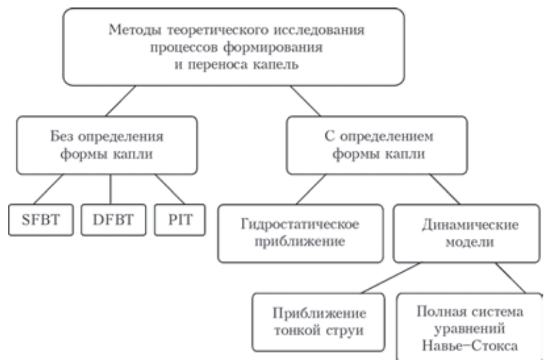
Рис. 1. Классификация методов теоретического исследования процессов формирования и переноса капель электродного металла
