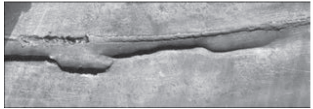
Рис. 9. Внутренняя поверхность трубы в зоне повреждения слоя глубиной до 3 мм (как известно, непровары у корневой части монтажного шва трубопровода диаметром 1000 мм и больше не допускаются). При этом присутствие указанных дефектов в данном случае однозначно не явилось причиной разрушения кольцевого соединения.
