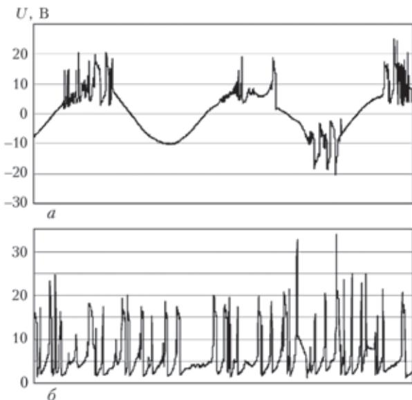
Рис. 7. Напряжение на губках контактной стыковой машины с источником переменного (а) и постоянного (б) тока при  $t = 50$  мс (а) и 25 (б)
