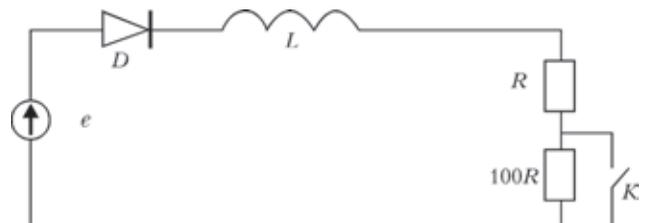
Рис. 8. Электрическая схема модели процесса оплавления на постоянном токе:  $e$  — напряжение на входе вторичного контура сварочной машины (выходе силового трансформатора);  $D$  — выпрямительный диод в источнике постоянного тока;  $L$  — индуктивность вторичного контура;  $R$  — условное сопротивление деталей при оплавлении;  $100R$  — условное переходное сопротивление оплавляемых деталей при переходе от режима оплавления в режим холостого хода
