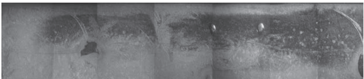
Рис. 3. Макроструктура ( \times 10 ) нанесенного слоя из меди марки М1 на кристаллизатор МНЛЗ методом СТП
