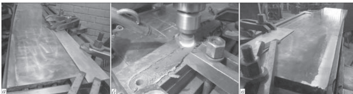
Рис. 7. Этапы нанесения медного слоя на медную плиту: а — плита с тонким медным листом; б — процесс наплавки; в — внешний вид восстановленной плиты после шлифовки
