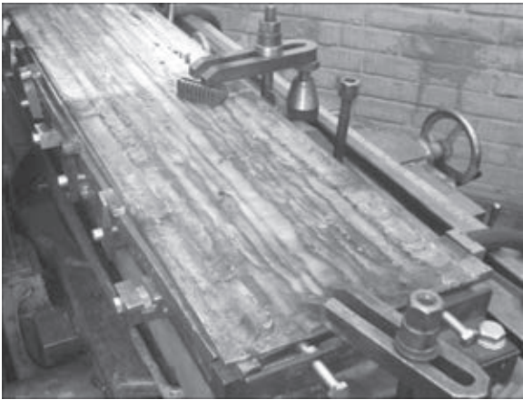
Рис. 8. Нанесенный на плите МНЛЗ слой меди (5 мм) методом СТП без водяного охлаждения
