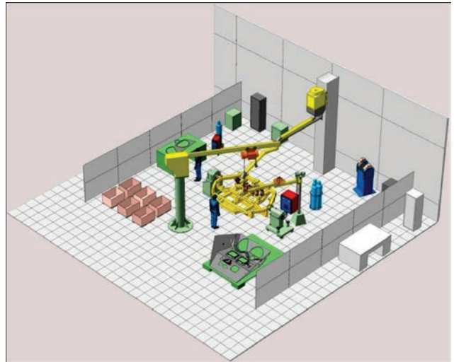
Пример сварочного участка для создания укрупненного узла сварного корпуса
