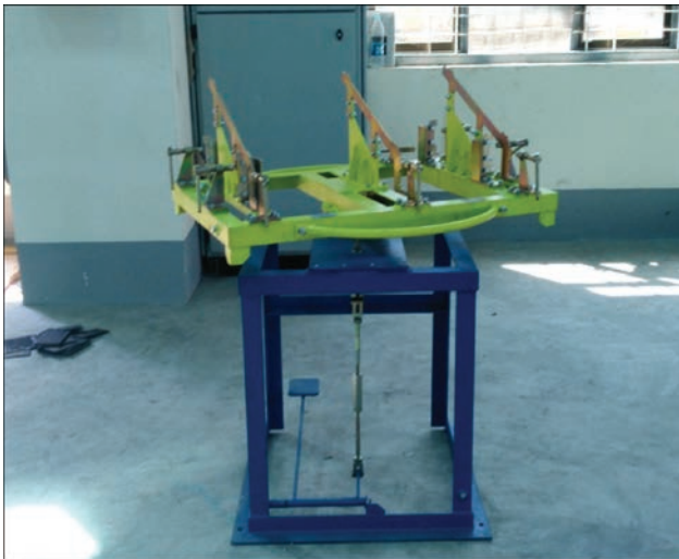
Установка для сборки и сварки элементов моторного отсека
