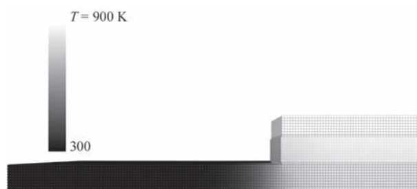
Рис. 7. Распределение температуры в поперечном сечении системы (показано 1/4 ее часть) при ее локальном разогреве в момент плавления припоя. Длина и ширина второй пластины в 3 раза превышают длину и ширину первой пластины
