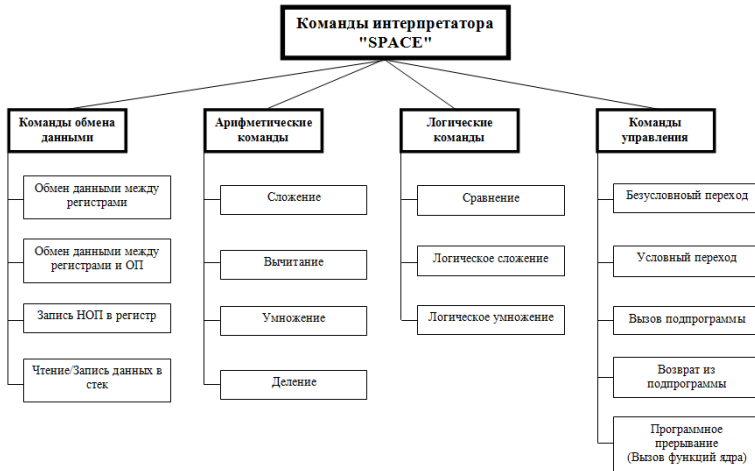
Рис. 6 – Типы команд интерпретатора
