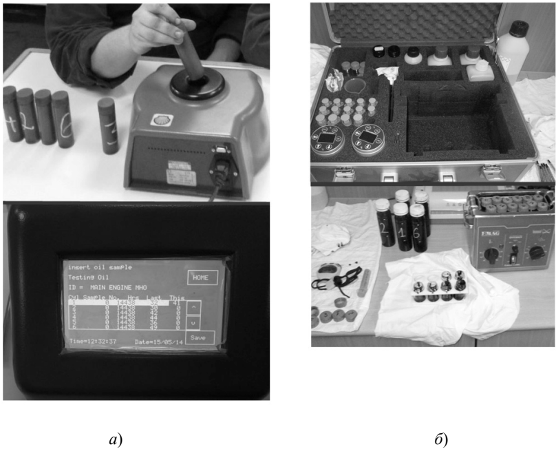
Рис. 5. Лабораторные комплекты для тестирования масла из подпоршневого пространства: а) – фирма Shell; б) – фирма GMT monitoring system
