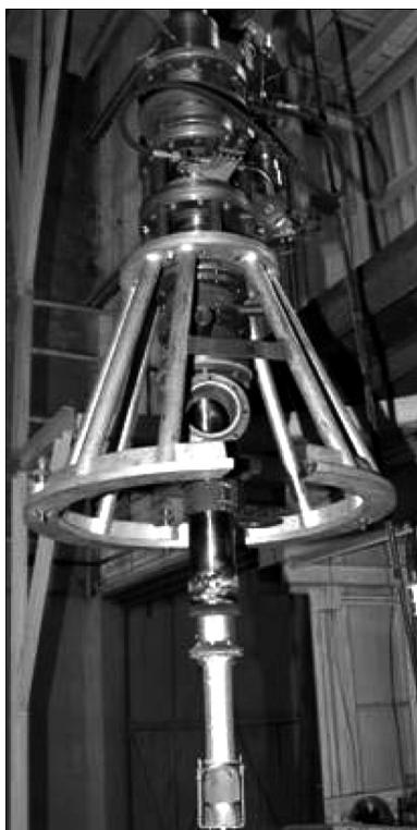
Рис. 1. Электродуговой испаритель металлов радиального типа с механизмом перемещения
