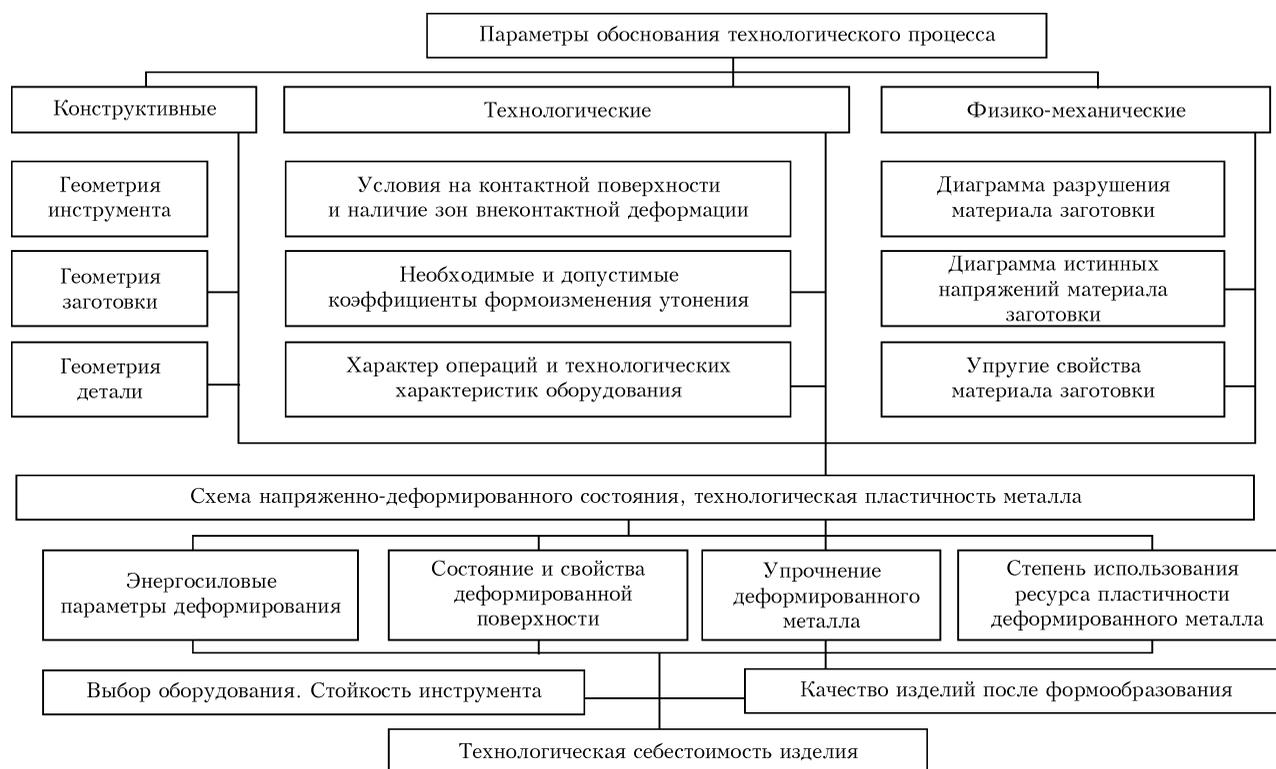
Рис. 1. Параметры процессов вытяжки
