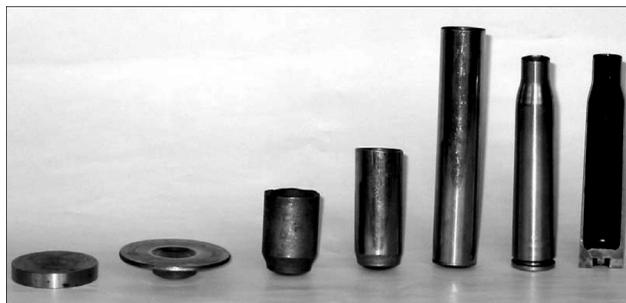
Рис. 18. Последовательность изготовления гильзы калибра 12,7 мм
