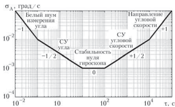
Рис. 2. Типичный график стандартного отклонения Аллана для данных угловой скорости MEMS-датчиков
