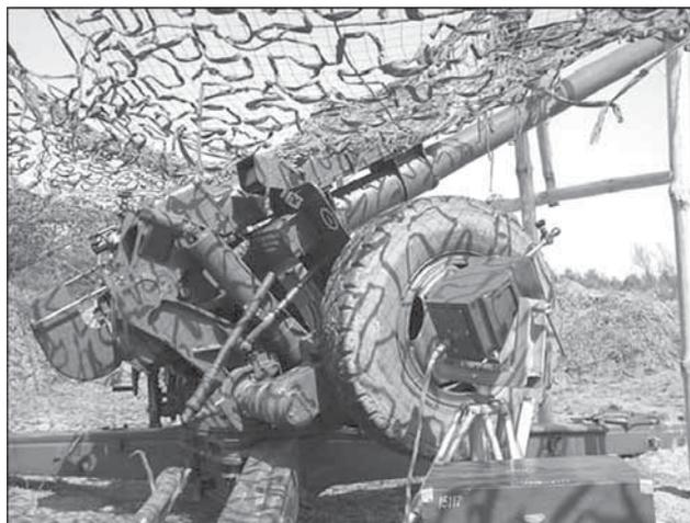
Рис. 3. Взаимное расположение гаубицы Д30 и артиллерийской баллистической станции при испытаниях
