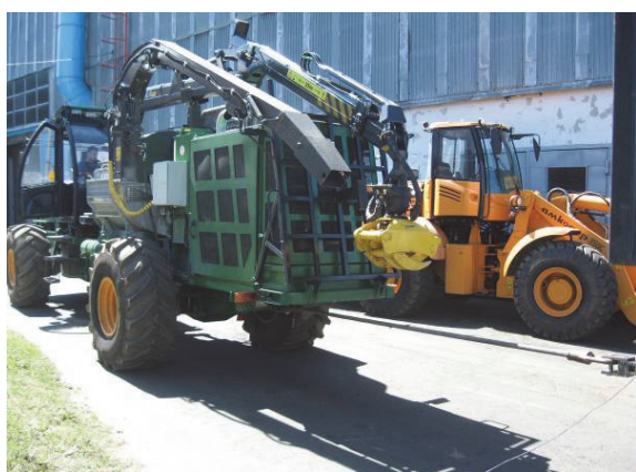
Рис. 8. Проведение замера усилия сопротивления движению
