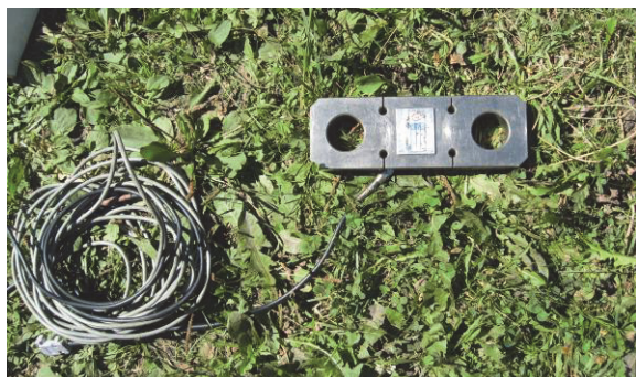
Рис. 4. Тензометрический датчик электронного динамометра ДОР-3-И-200
