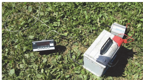
Рис. 5. Размещение электронного динамометра ДОР-3-И-200 с индикатором WI-4, подключенного к питанию аккумулятора через преобразователь электрического тока
