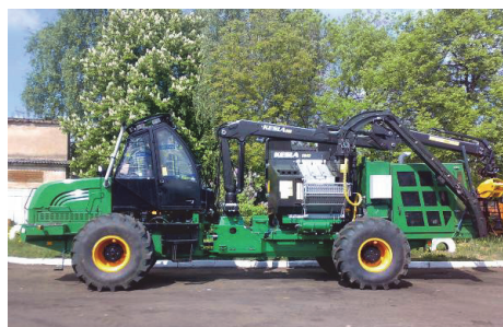
Рис. 1. Объект исследовательских испытаний – мобильная рубильная машина АМКОДОР 2904
