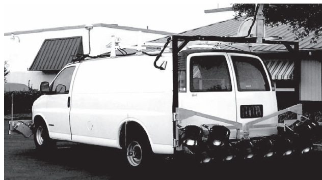
Рис. 3. Лабораторія фірми ICC з лазерним сканером та обладнанням для запису відеозображення поверхні покриття та облаштування дороги, США
