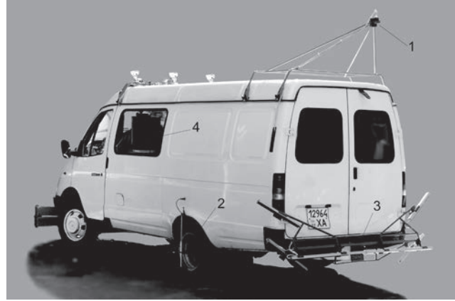
Рис. 6. Система відеосканування покриттів "ОКО" на базі автомобіля ГАЗ 2705: 1 – промислова лінійна відеокамера; 2 – датчик відстані; 3 – система освітлення покриття; 4 – промисловий бортовий комп'ютер
