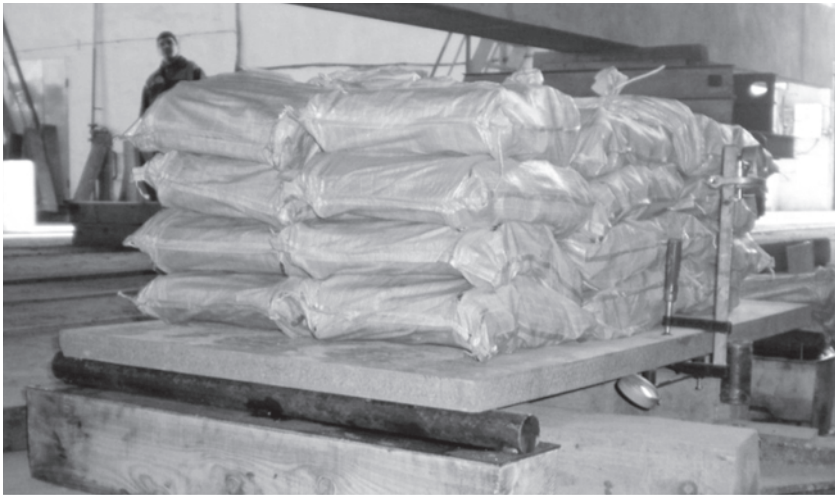
Рис. 8. Випробування деревостружкової плити на цементному в'язучому ВЕТОНУР для незнімної опалубки
