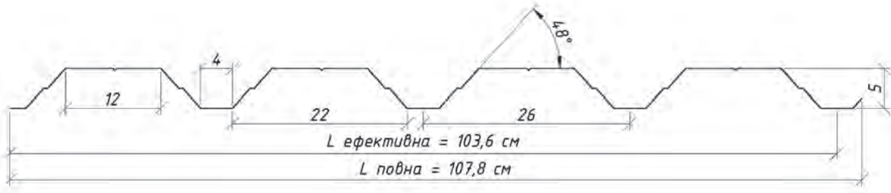
Рис. 4. Розміри металевого профільованого листа Т-50
