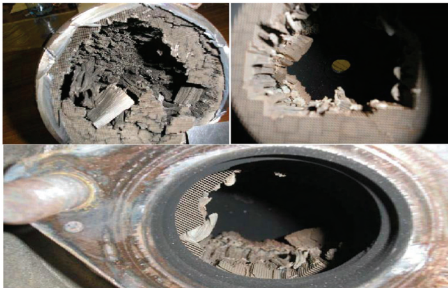
Рис. 3. Зруйнування керамічного носія каталітичного шару, спричинені вибухоподібним займанням накопичених парів паливно-мастильних матеріалів
