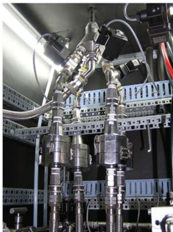
Рис. 6. Тримачі фільтрів для зважування часток, верхні клапани розподілення потоків та система розподілення потоків оригінальної конструкції
