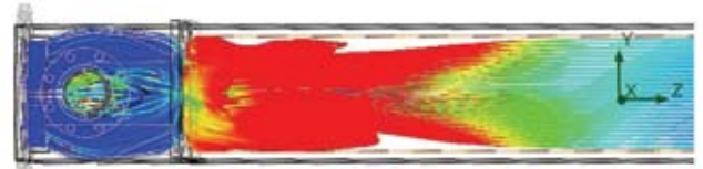
Рис. 3. Приклад розрахунку параметрів потоку ВГ, повітря і їхньої суміші у змішувачі та на вході в повно-потоківий тунель (на зображенні показано зони різної турбулентності потоку)
