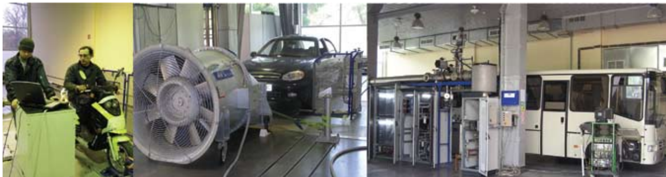
Рис. 8. Випробовування КТЗ у широкому діапазоні мас і, відповідно, потоків ВГ із використанням універсальної системи моделі EMMS-CVS-010 (випробовування мопеда, легкового автомобіля та автобуса)
