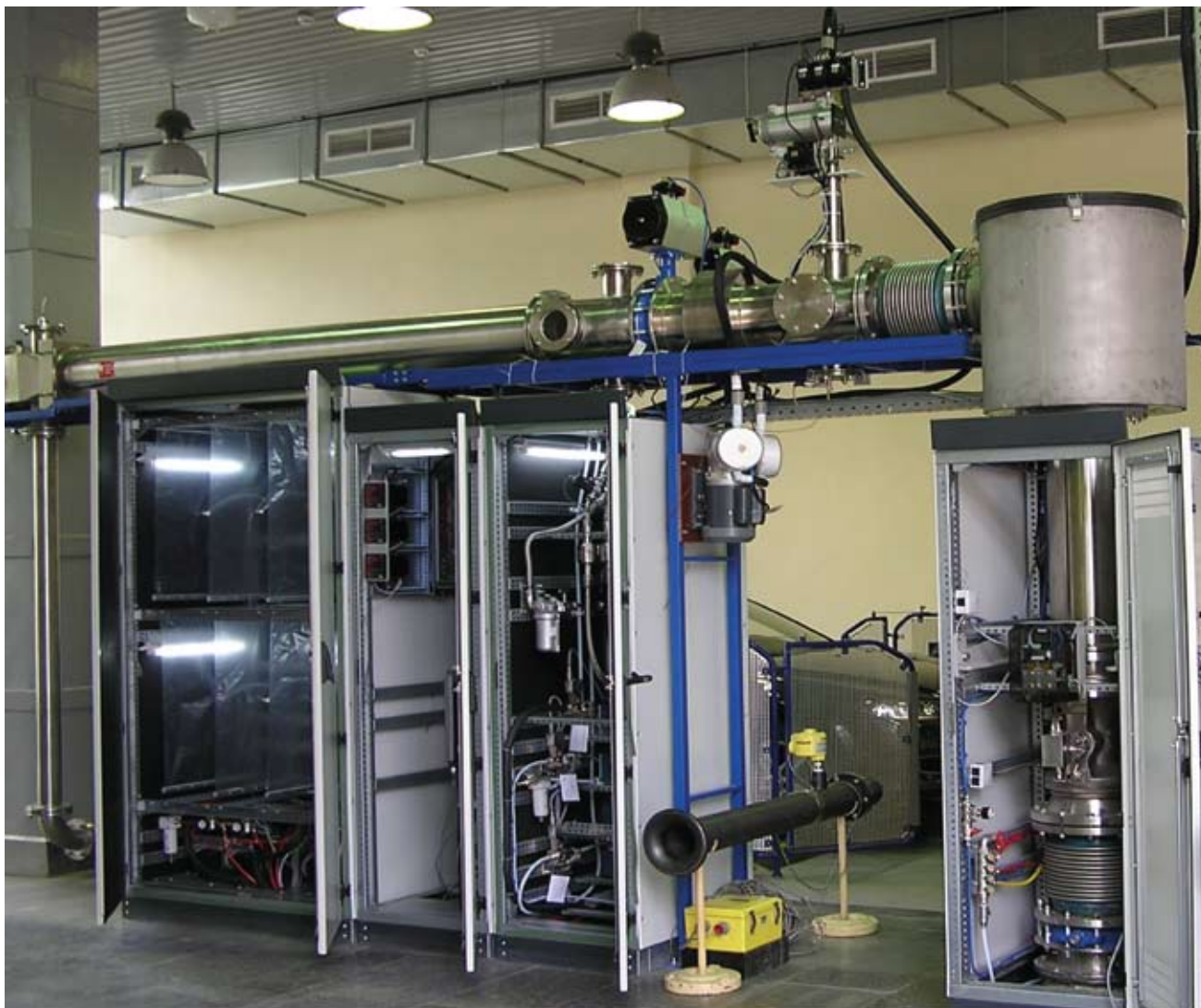
Рис. 7. Загальний вигляд основної частини елементів повно-потокової системи моделі EMMS-CVS-010
