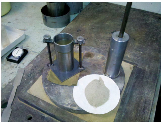
Рис. 1. Пристрій для ущільнення піску у фільтраційному циліндрі приладу КФ-00М
