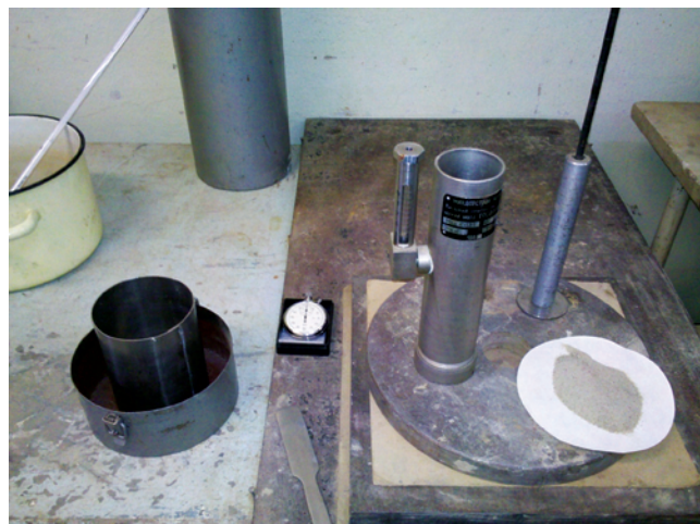
Рис. 2. Прилад конструкції В.С. Сиралева для фільтраційних випробувань ущільнених зразків піску
