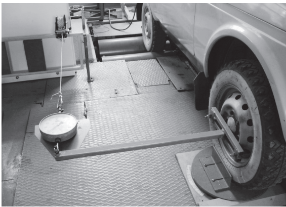
Рис. 5. Визначення жорсткості приводу рульового керування (фронтальний вигляд)
