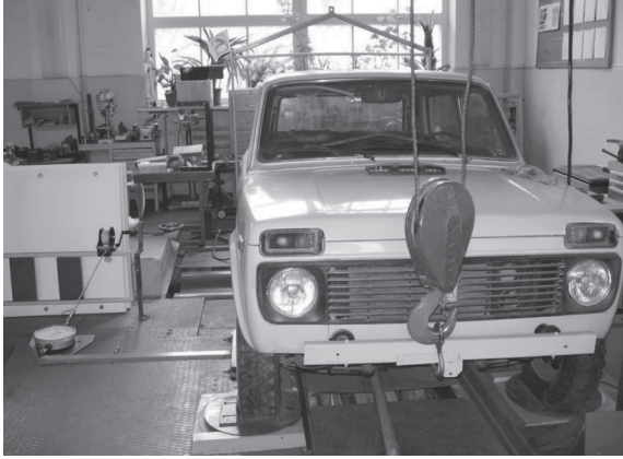
Рис. 4. Визначення жорсткості приводу рульового керування
