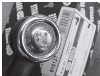
Рис. 10. Маркування виконане на кришці наконечника рульової тяги ударним методом з позначенням марки виробника та дати виготовлення
