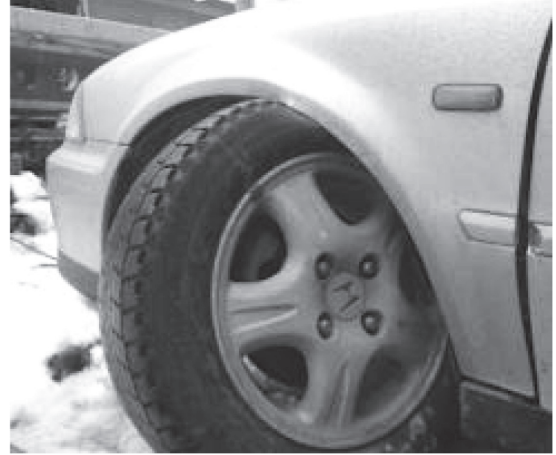
Рис. 4. Наслідки виривання кульового пальця із корпуса
