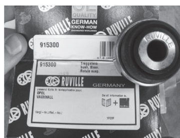
Рис. 14. Маркування виконане ударним методом на внутрішній металевій втулці шарніра гумово-металевого. На пакуванні зазначений номер частини за каталогом RUVILLE та модель транспортного засобу, на якій він застосовується
