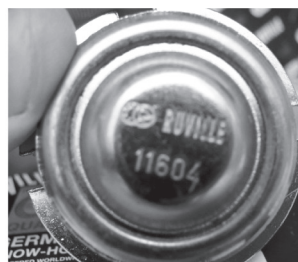
Рис. 12. Маркування виконане на кришці кульової опори ударним методом з позначенням марки виробника та дати виготовлення
