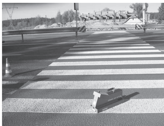
Рис. 2. Визначення коефіцієнтів світлоповертання ( R_L ) та яскравості ( Q_d ) за допомогою приладу Ретрорефлектометр ZRM 1013+
