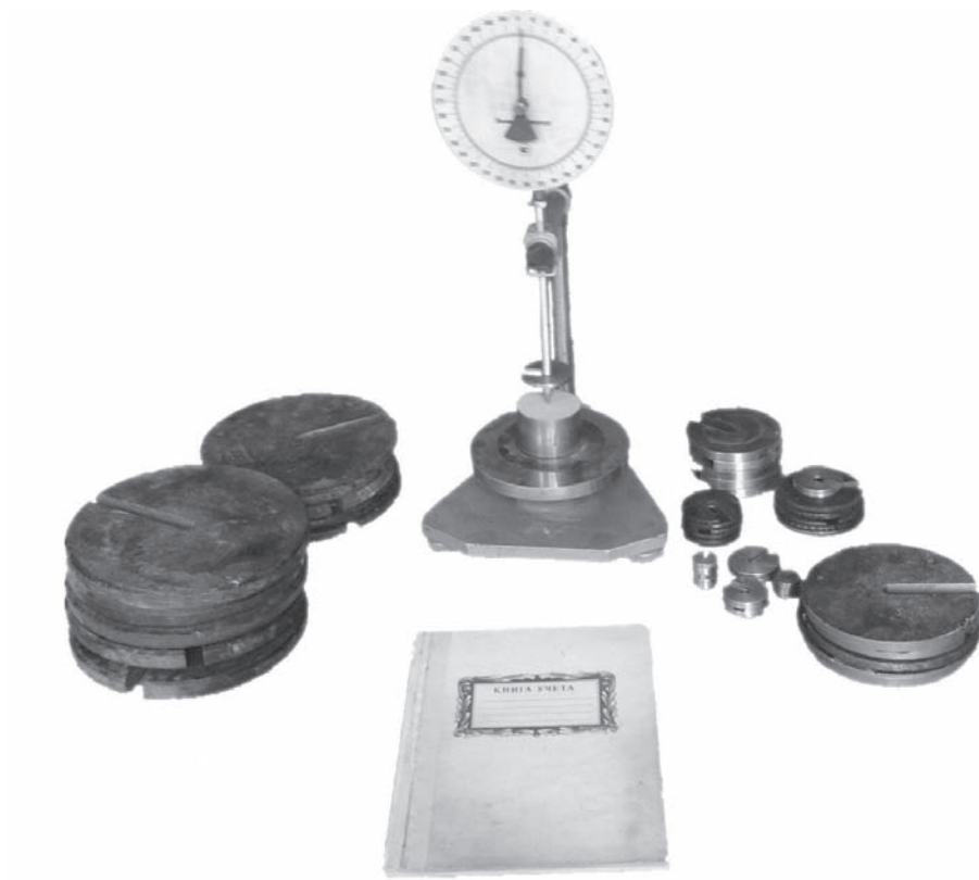
Рис. 9. Лабораторний пенетрометр типу ЛП – 1 та диски навантаження
