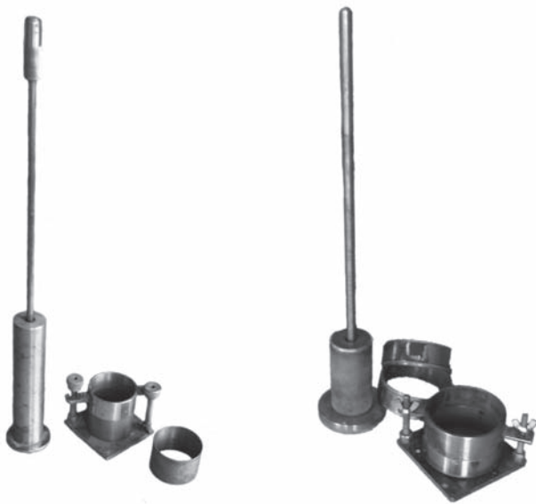
а) кільця невеликого діаметру ( d = 5,69 \text{ см} ) і пристрій для ущільнення в них ґрунтів б) кільця великого діаметру ( d = 10,45 \text{ см} ) і пристрій для ущільнення в них ґрунтів
