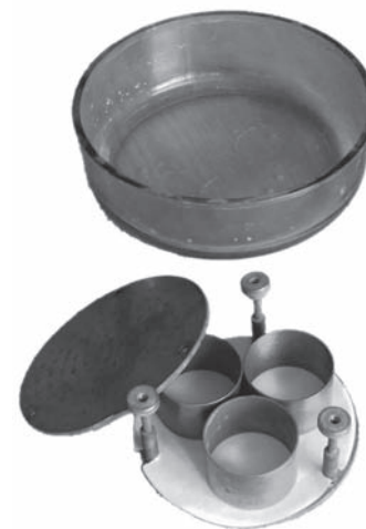
Рис. 8. Пристрій для водонасичення ґрунтів під вакуумом
