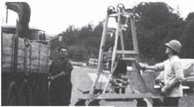
Рис. 6. Прототип установки FWD, DTU, Данія
