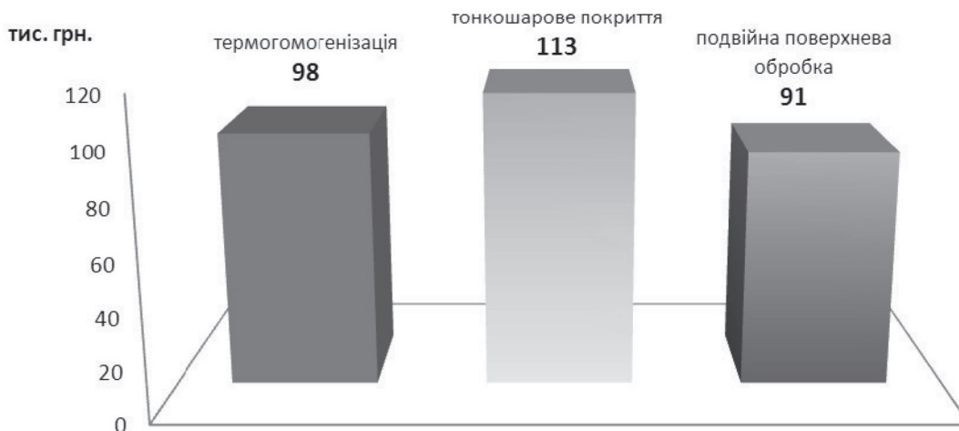
Рис. 2. Порівняння вартості ремонтних робіт 1000 м 2 асфальтобетонного покриття
